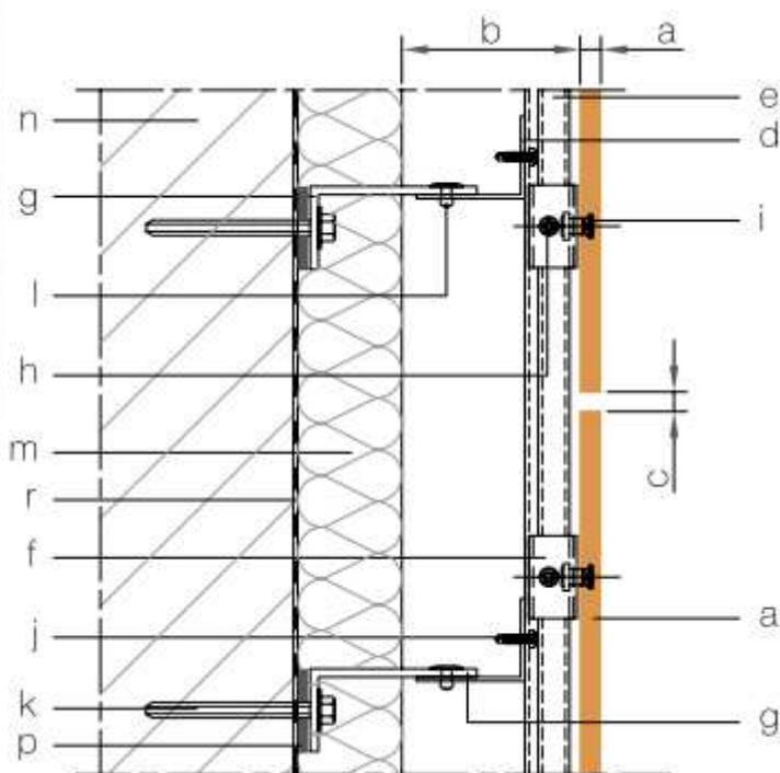
Fig.2 dettaglio giunto pannello verticale
