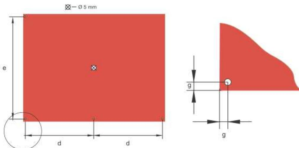
Praticare un foro di 1,5 x diametro di vite/rivetto in maniera tale da lasciare lo spazio necessario per i movimenti del pannello. Utilizzare punte da trapano in acciaio temprato.
