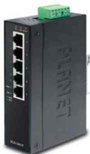
L'apparato mod. IGS-501T è uno Switch industriale a guida DIN, dotato di n. 5 porte 10/100/1000Mbps specificamente progettato per funzionare in modo affidabile anche in ambienti climaticamente impegnativi con temperature esterne da -40° a + 75°.
