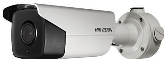
Dovranno essere telecamere fisse di ultimissima generazione con sensore CMOS da 1/2.8" a scansione progressiva da 3 Megapixel 2048 (H) x 1536 (V) e dispositivo WDR 120dB, illuminazione minima 0,005 lux (F1.2) in modalità a colori e 0.00 lux in modalità monocromatica con faro IR attivo e poter trasmettere le relative immagini codificate in H264 o M-JPEG tramite interfaccia Ethernet RJ45.
